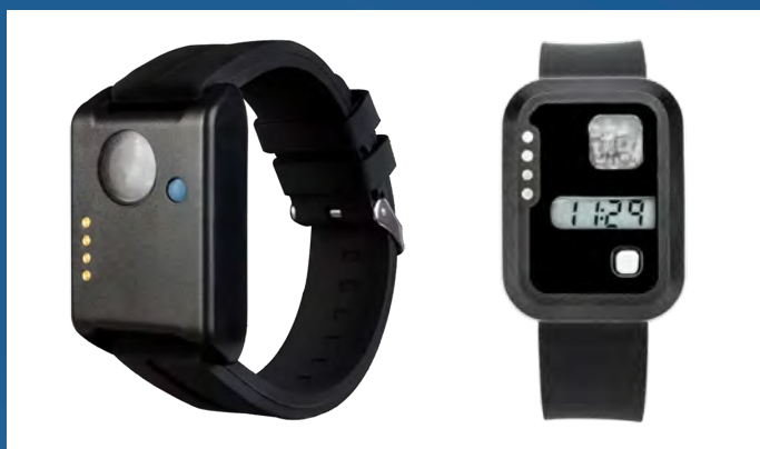
Figura 2. Actígrafos ActTrust 1 (esquerda) e ActTrust 2 (direita). Fonte: Condor Instruments.
