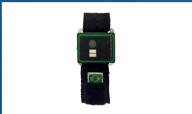
Figura 1. Actígrafo nacional ACT10, produzido pela companhia CE Brasil, também chamado “Tempatilumi” por pesquisadores. Fonte: captura por Daniel Vartanian.
